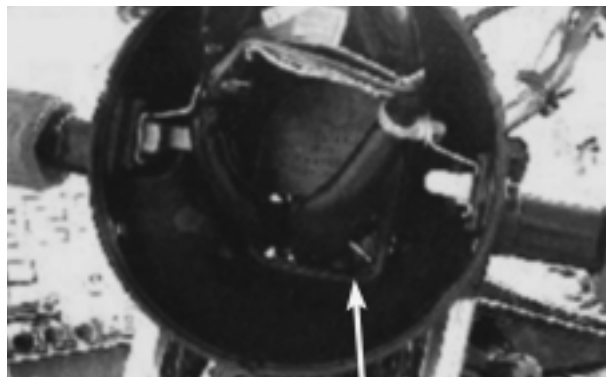
FIAÇÃO SOLTA NO INTERIOR DA CARÇAÇA
